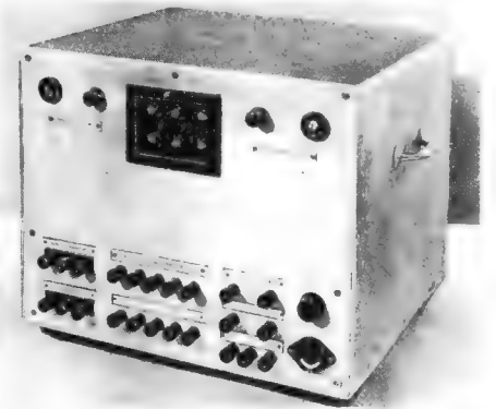
Ansicht des eingebauten Gerätes nach Schaltung D. In der Mitte oben, hinter einer abnehmbaren Plexiglastafel, befinden sich die Glühlampen-Sicherungen zum Schutz der Transformatoren gegen Heizfaden-Anoden-Schluß
