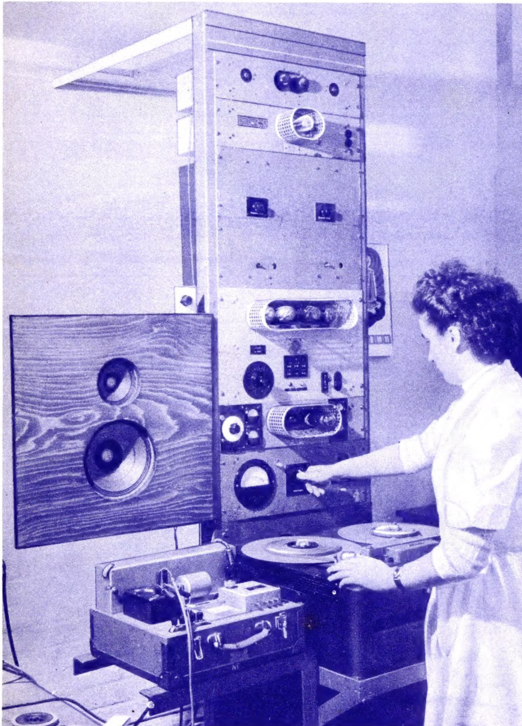
Mit dieser Bandprüfeinrichtung des Rundfunk-Technischen Instituts in Nürnberg werden alle Magnetophonbänder, die im Rundfunkbetrieb unserer Sender für die Schallaufnahme Verwendung finden, einer genauen und vielseitigen Prüfung unterzogen. Von der sorgfältigen Prüfung dieser Bänder hängt der reibungslose und einwandfreie Ablauf mancher wertvollen Rundfunkübertragung ab. (Foto: Carl Stumpf)
